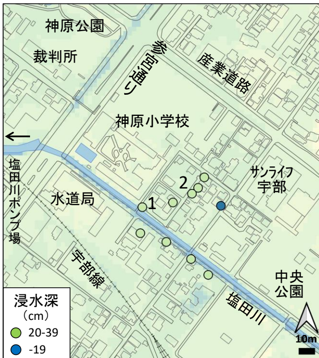
図 15.3 神原小学校南東付近の実測浸水深（建物が面した道路から浸水痕跡までの高さ、cm）と水位計の設置場所（1・2は写真の位置）（宇部市デジタル推進室（2025）より転載・加筆）
