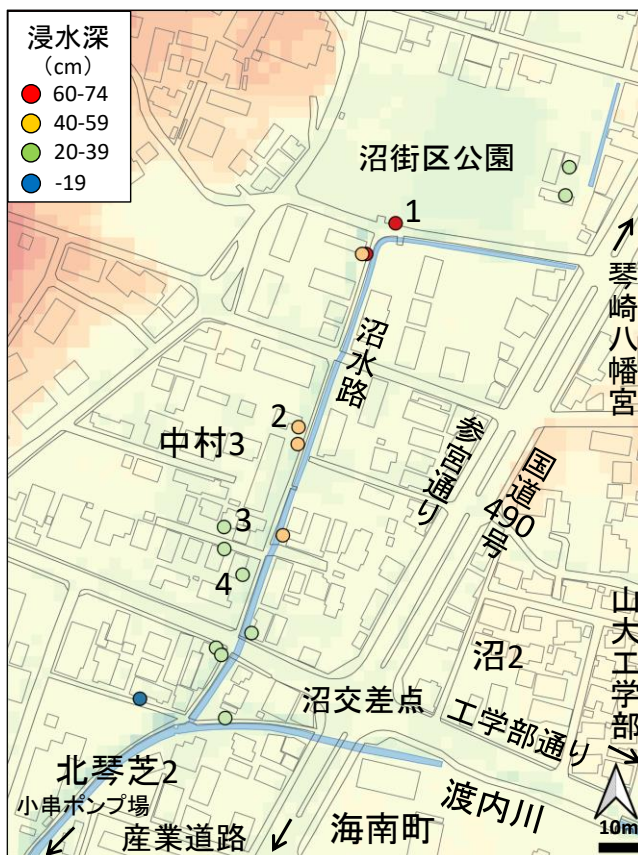
図 15.1 参宮通りの沼交差点の西側付近の実測浸水深（建物が面した道路から浸水痕跡までの高さ、cm）（1～4は写真の位置）（宇部市デジタル推進室（2025）より転載・加筆）
