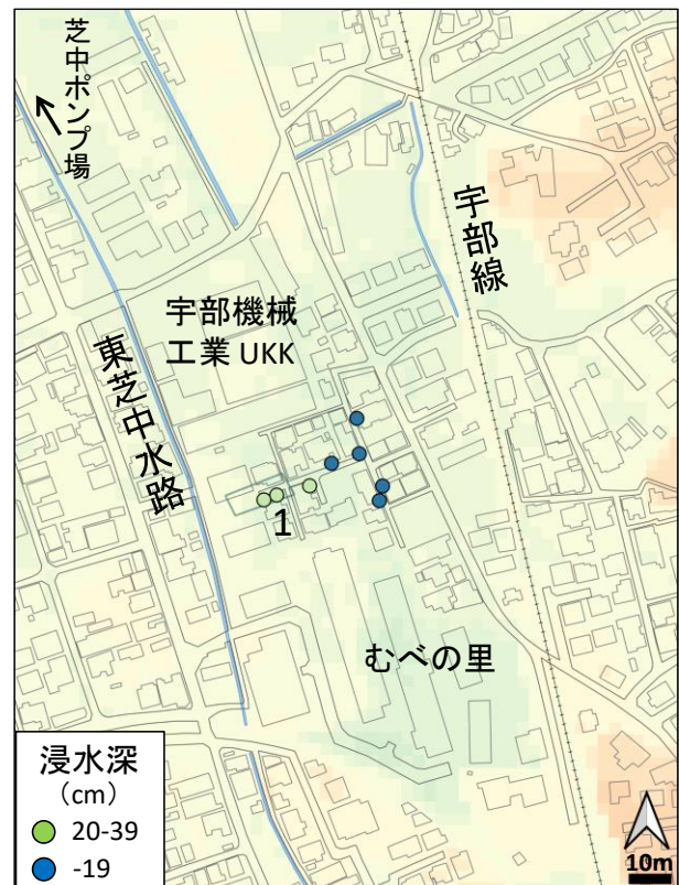
図 15.4 東芝中町付近の実測浸水深（建物が面した道路から浸水痕跡までの高さ、cm）と水位計の設置場所（1は写真の位置、青色枠は過去の浸水範囲）（宇部市デジタル推進室（2025）より転載・加筆）
