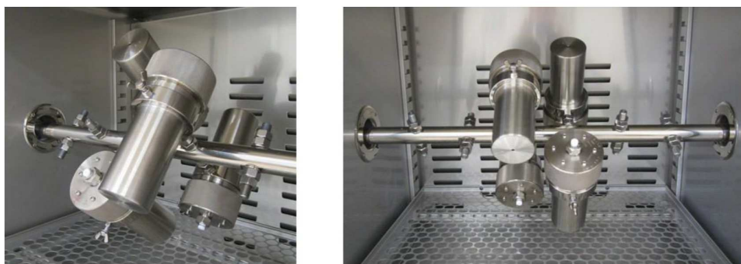
図 3-1 水熱反応中における容器の攪拌状況（回転数：20 rpm）
