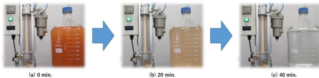
図 1-2 ウォラストナイト製セラミックフィルターを用いた懸濁液の連続ろ過試験
