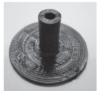
図4 3Dプリンターで製作した「おもりをのせる台」
