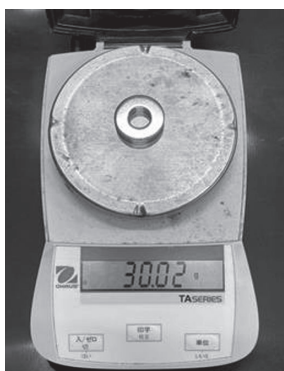
図14 電子天秤を使って、おもりの重さ(質量)を量っているようす
