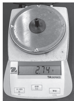
図12 電子天秤を使って、「おもりをのせる台」の重さ(質量)を量っているようす
