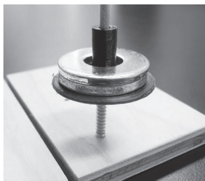
図15 「おもりをのせる台」を取り付け、その上におもりをのせたようす
