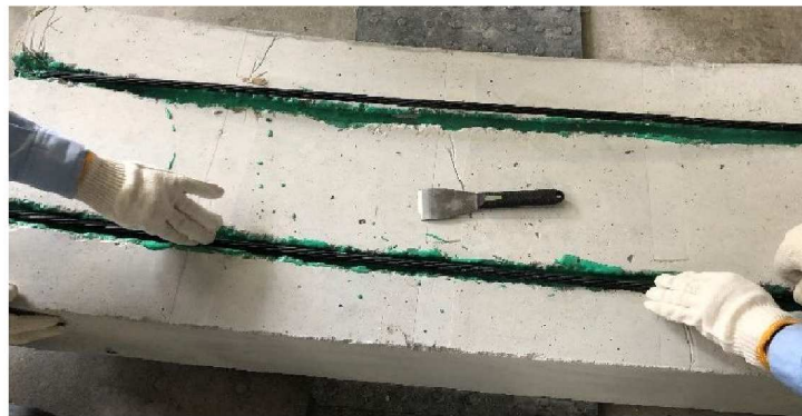
写真-3.3.1 NSM-CFCC 供試体の作製状況例（CFCC：2本、250mm 間隔）
