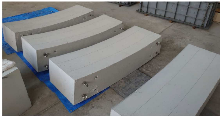
b) 供試体養生状況
