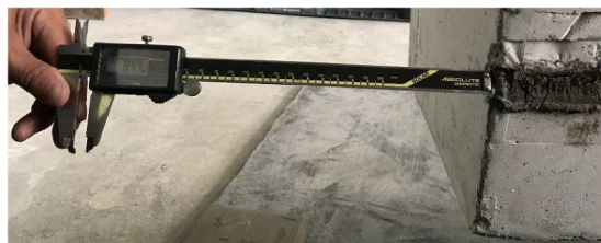
写真-3.4.4 端部すべり（最大すべり量：8.4mm）
