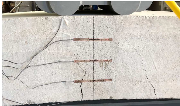
写真-3.4.2 ひび割れ例
