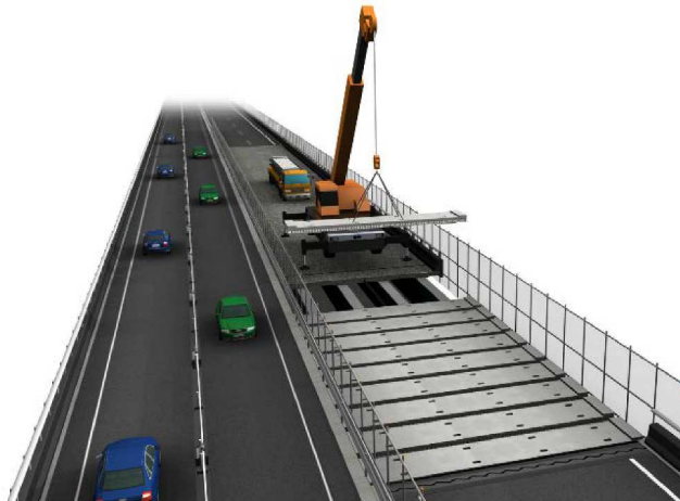
図-4.1.1 床版取替工事
