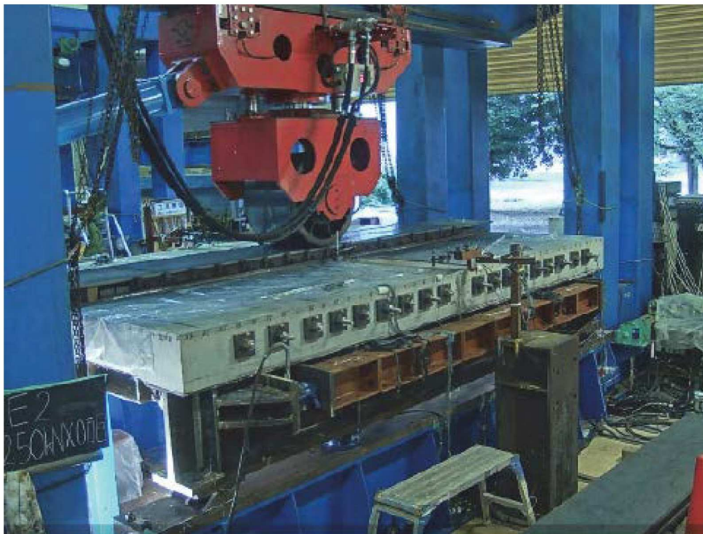
図-5.2.4 輪荷重走行試験状況（負曲げ有り）
