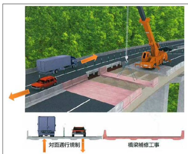
図-1.1.21 車線規制を前提とした床版取替の施工状況 20)
