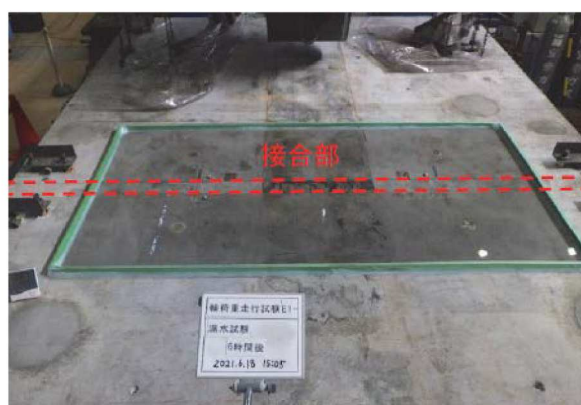
図-5.2.6 漏水確認試験
