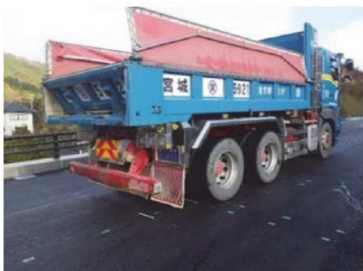
図-5.4.4 静的載荷状況（トラック静止）
