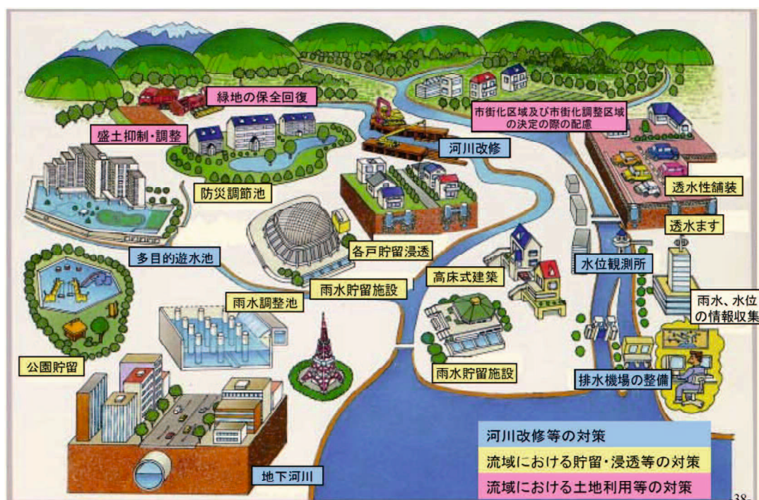
図-2.1.3 総合治水の概念図 (総合治水対策のプログラム評価に関する検討会資料 2-2) )
