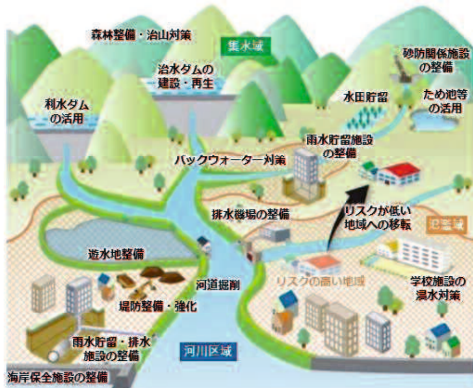
図-1.1.1 流域治水の概念図（出典：「流域治水」の基本的な考え方 1-1) ）
