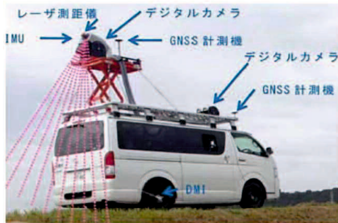
図 4.4.5 MMS による堤防での計測イメージ 5)
