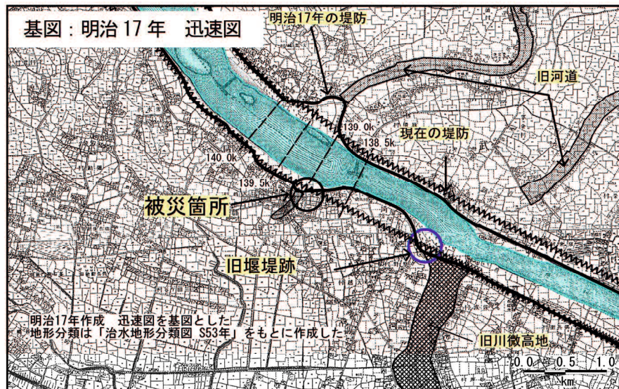
図 3.2.6 明治 17 年当時の堤防と現在の堤防の比較 7)
