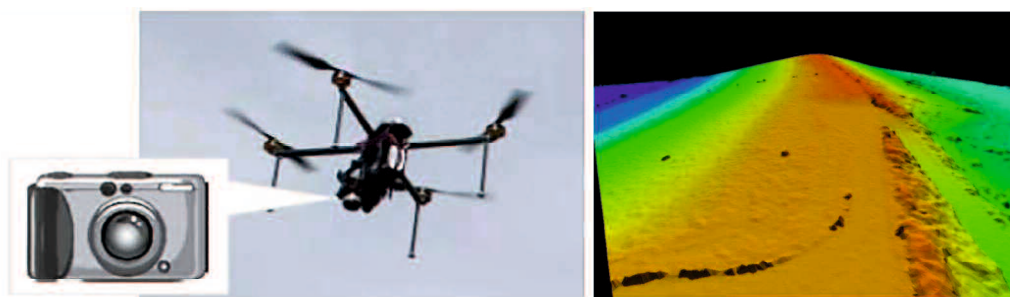
図 4.4.6 UAV 搭載カメラと SfM による堤防 3 次元モデルデータ作成イメージ 2)
