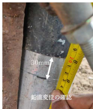
図-4.5 コーナーリフレクタの変位調整
