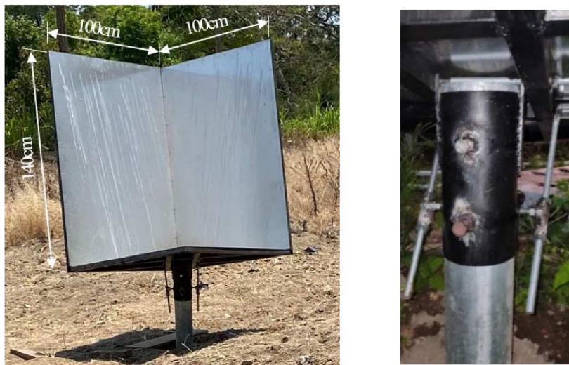
図-4.1 変位計測精度検証用コーナーリフレクタ
