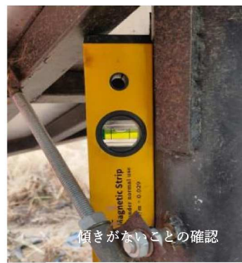
図-4.5 コーナーリフレクタの変位調整
