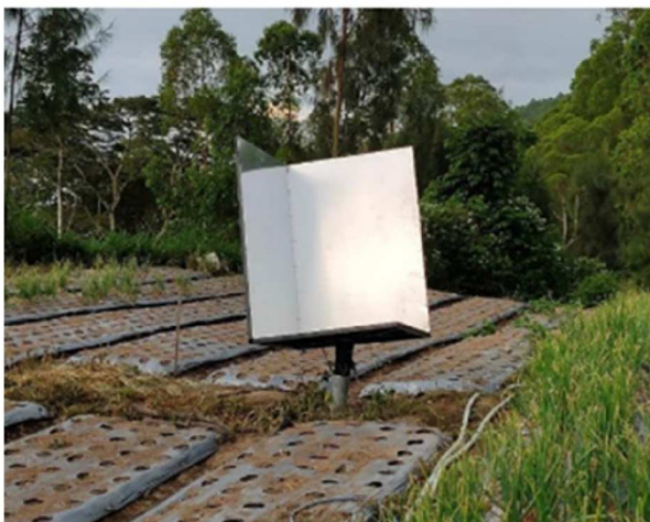
図-4.3 コーナーリフレクタ設置状況 (2022年5月撮影)
