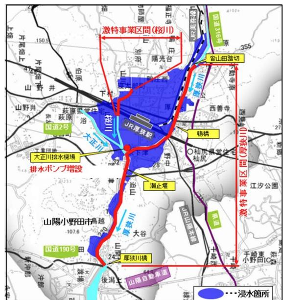
図10 厚狭川の河川激甚災害対策特別緊急事業(激特事業)の概要(山口県宇部土木建築事務所、2019)
