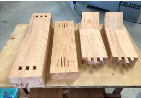
図7 獅子台座の框枠組の仕口
