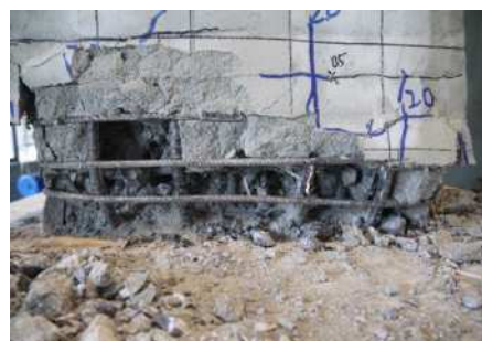
(c) 低強度 PCM 吹付け補強供試体 Case-4
