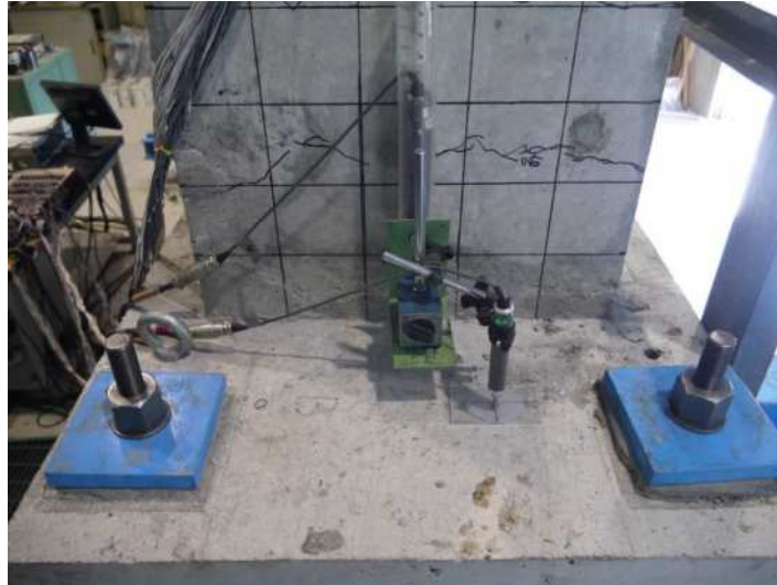
図-2.6 Case-2 供試体回転変形計測用変位計
