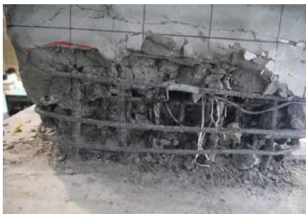
(b) 高強度 PCM 打ち込む補強供試体 Case-3
