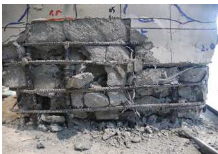
(c) 低強度 PCM 吹付け補強供試体 Case-4
