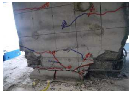
(b) 高強度 PCM 打ち込む補強供試体 Case-3
