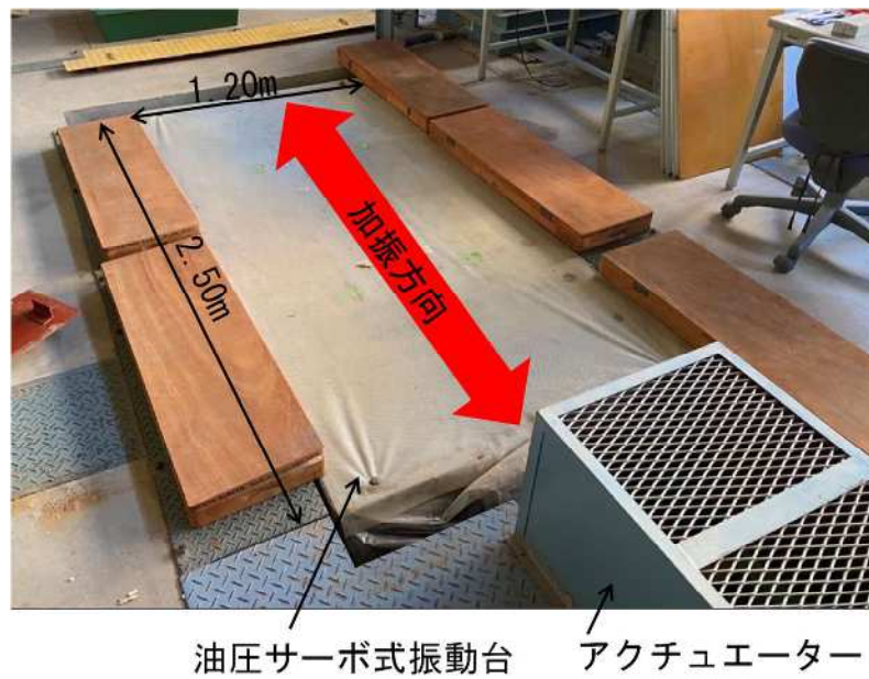
図-4.3 振動台全景
