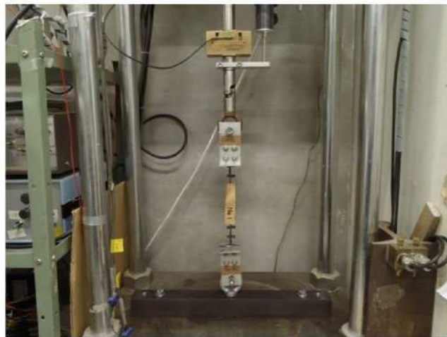
写真-2.1 ジオテキスタイル引張試験状況 7)
