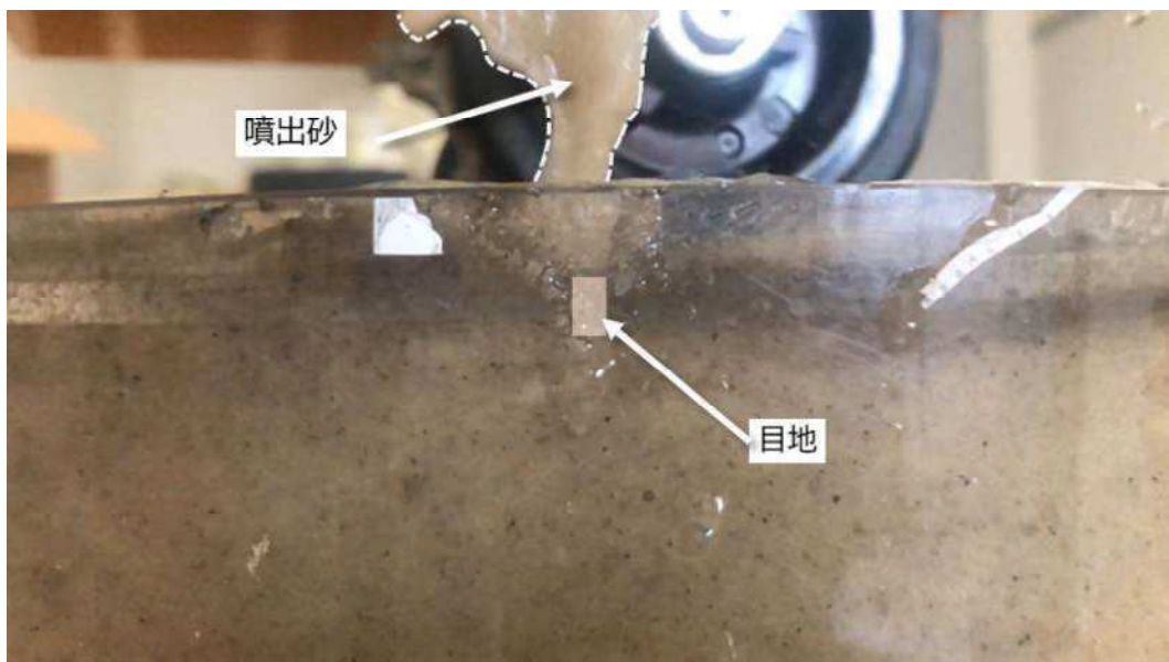
図 3-5 輪荷重周回型模型を用いた予備実験における路盤材噴出状況
