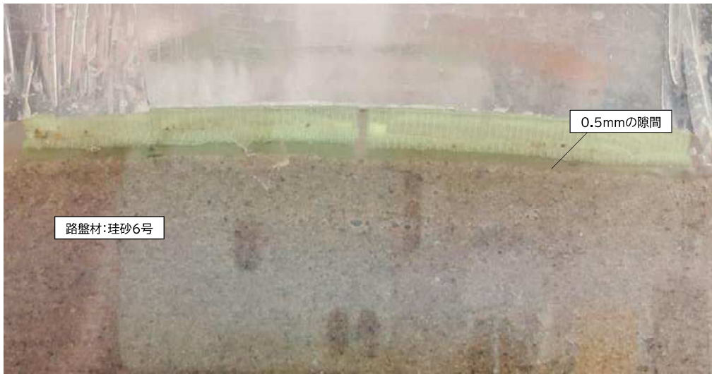
図 4-26 舗装版と路盤の間に隙間を設けたケースの検証実験
