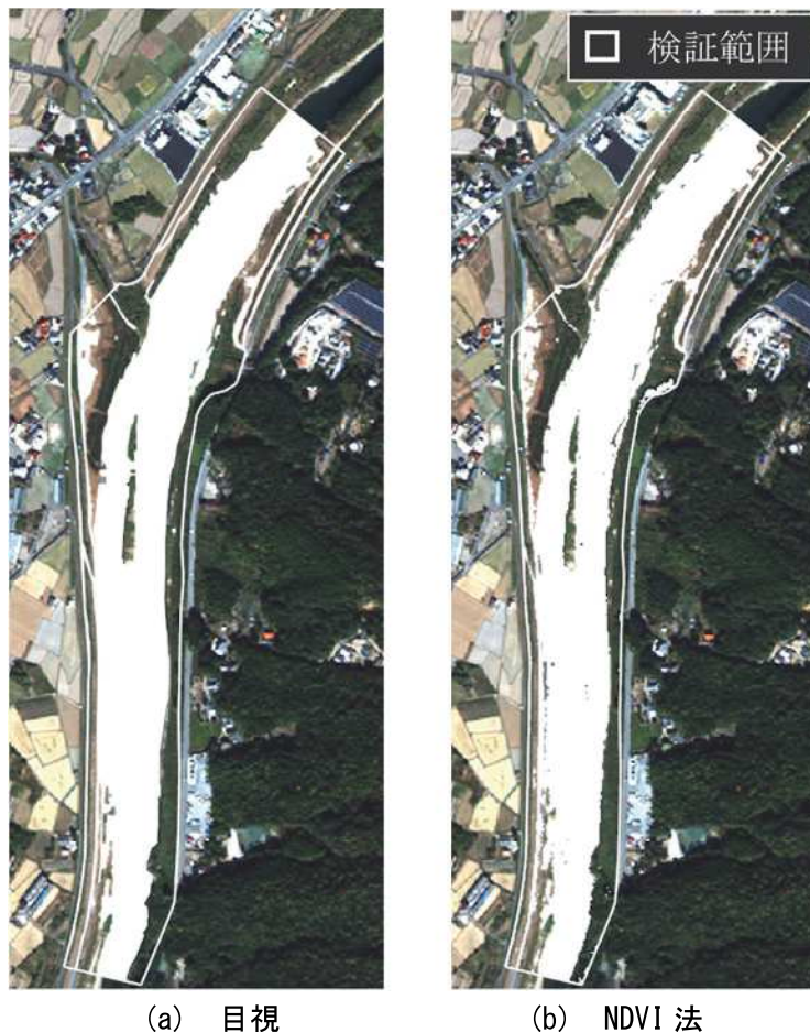
図-4.2.10 目視およびNDVI法における植生抽出結果
