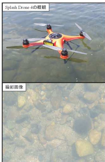
図-3.3.1 SplashDrone4 の概観および撮影画像
