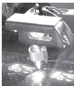
加工中のレーザーヘッド部
