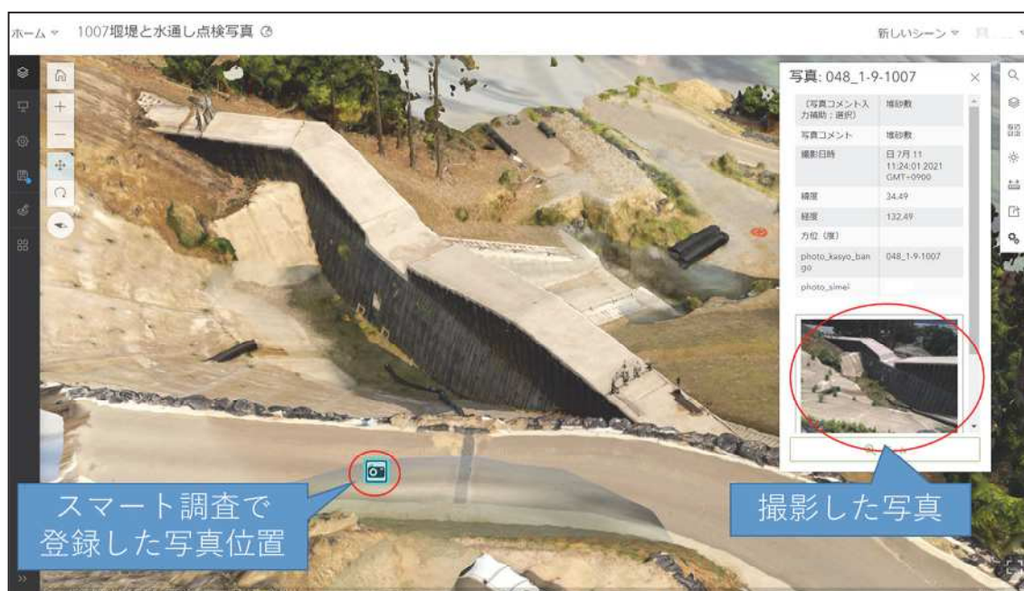
図5-9 3次元モデルとGISデータの重ね合わせ
