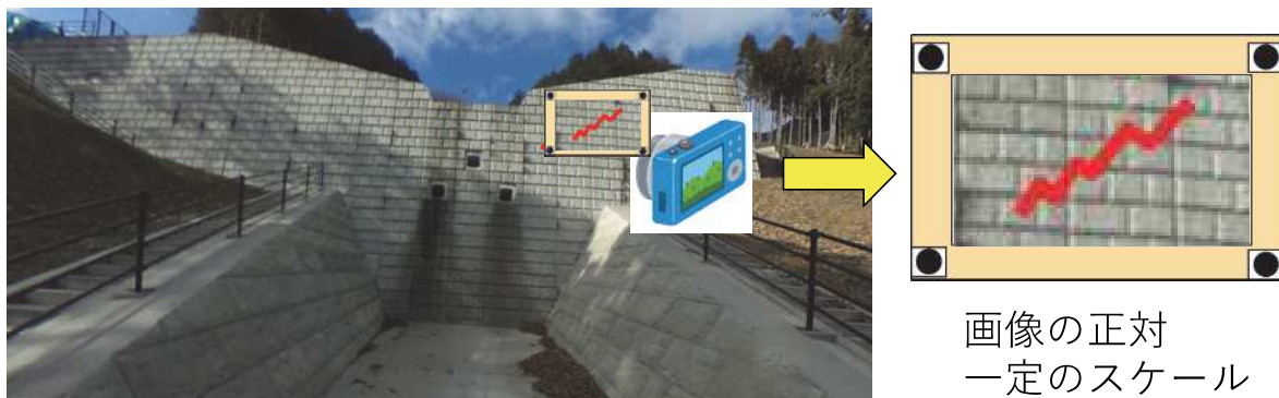
図 4-3 経年劣化記録手法のイメージ
