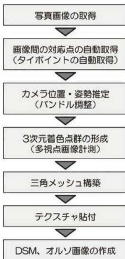
図 2-15 SfM/MVS による 3 次元モデル作成手順 49)
