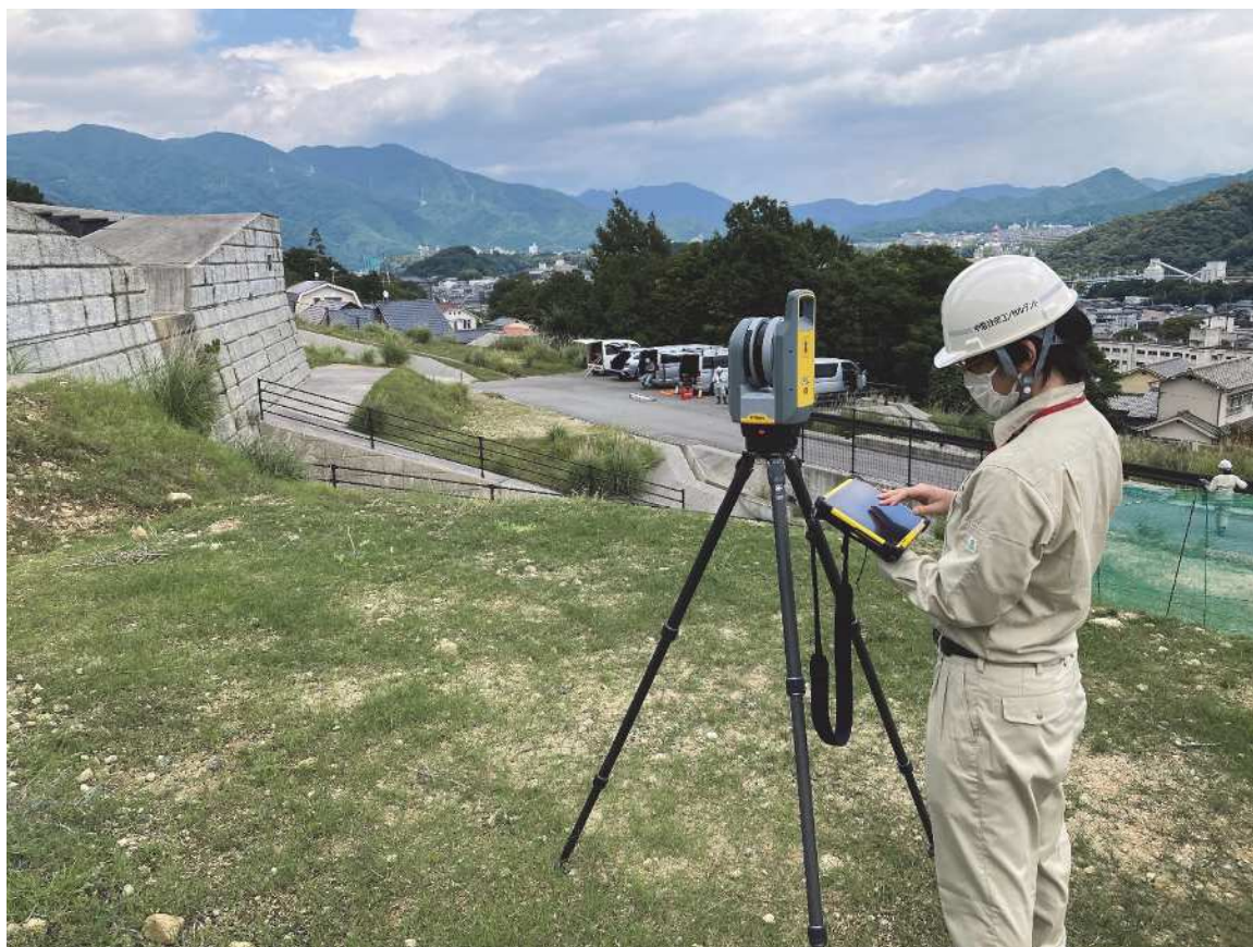
図 2-12 地上レーザ測量実施状況
