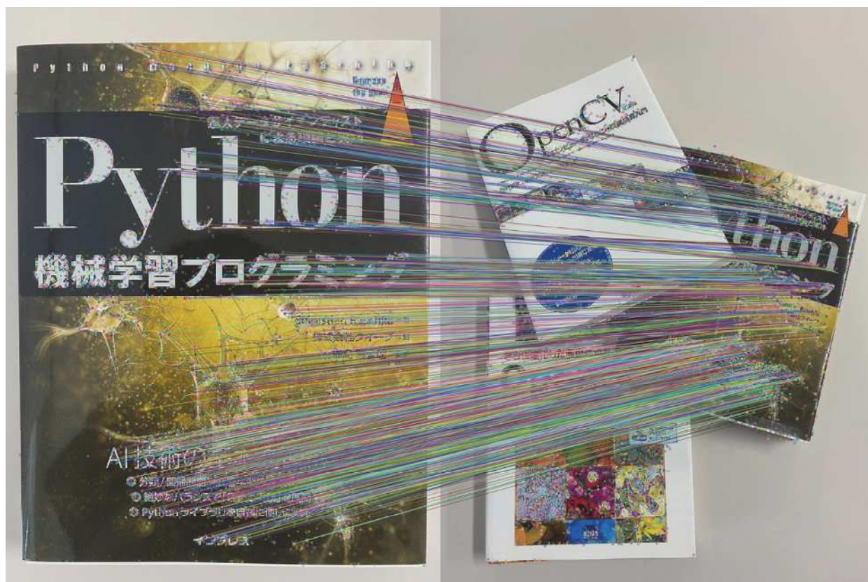
図 4-10 特徴点マッチングを行った結果のイメージ
