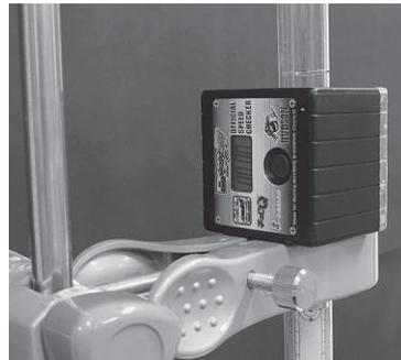
図 15 おもりの速さ測定器を取り付けたようす
