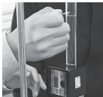
図18 実験のようす(銅板を引いて金属球を落下させた後のようす)
