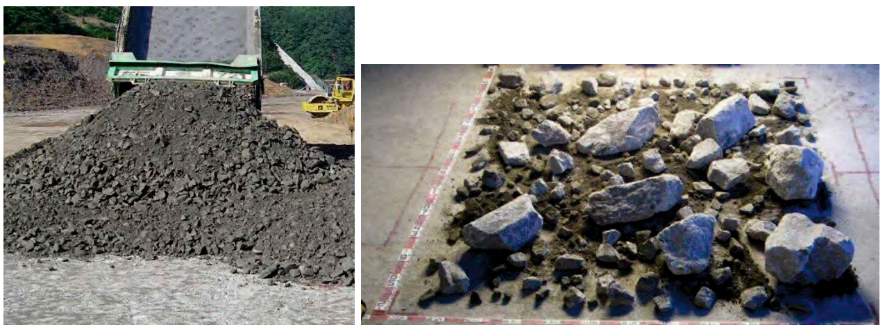
写真 1-1 ロックフィルダムの粗粒フィルター材とロック材 (藤崎, 2014)
