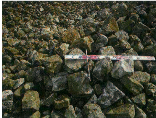
写真 1-2 道路盛土材料として利用される岩砕(花輪, 2011)
