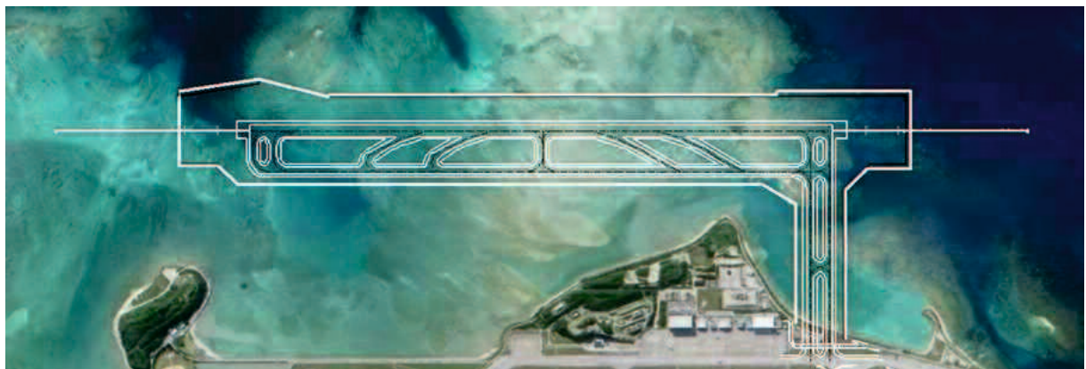
写真 1-4 サンゴ礫混じり土を地盤に含む那覇空港第二滑走路(内閣府沖縄総合事務局ホームページ)
