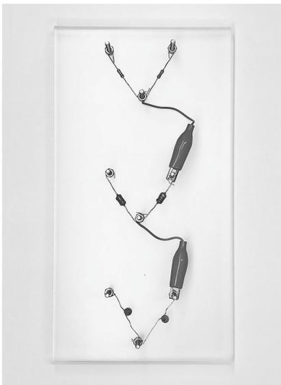
図 9. 実際に作製した教材。上から抵抗、コイル、コンデンサーが各 2 個ずつ設置されている。
