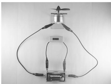
図12 乾電池1個の電圧の測定
