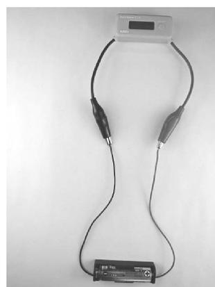
「電池の種類（単一電池と単三電池）が違っても、新品の1.5V乾電池の電圧（ボルト）は同じである。」ことを実験で確かめる。
