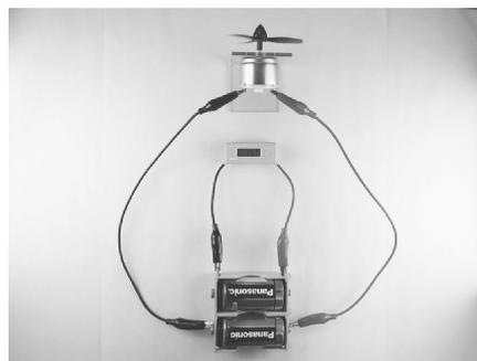
図15 乾電池2個の並列つなぎの電圧の測定
