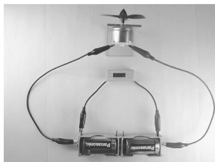
図13 乾電池2個の直列つなぎの電圧の測定
