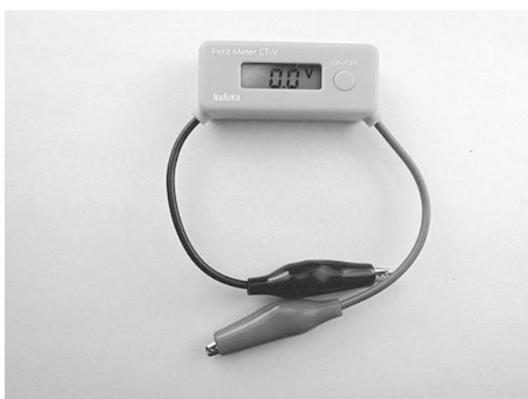
図3 小学校で新しく使用するデジタル電圧計
