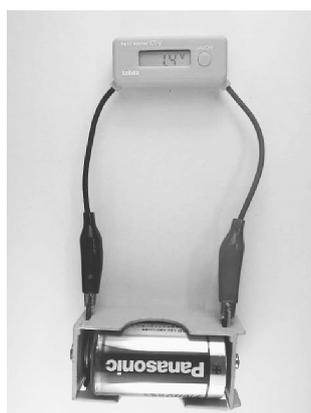
同じ種類の乾電池（単一電池）の使えないものと新品のものの電圧を測り、比較する。「新しい乾電池の方は○V（ボルト）、古いものは□V（ボルト）で新しいものの方が電圧が大きい。」ことを実験で確かめる。
