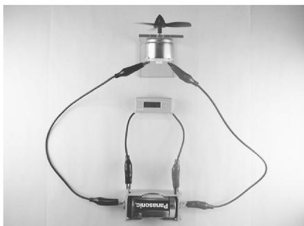
図14 乾電池1個の電圧の測定
