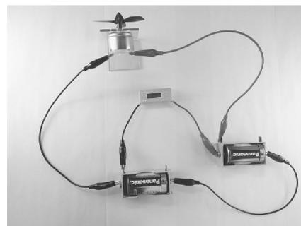
図16 乾電池2個を逆につないだ時の電圧の測定
