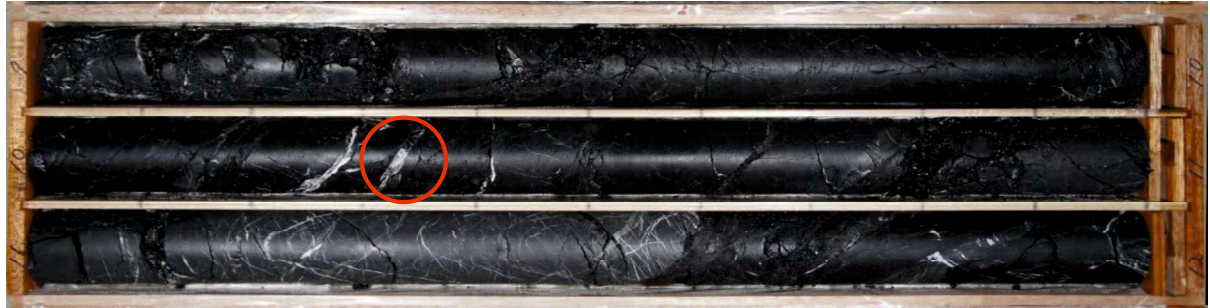
図 4.7-1 カルサイト双晶の測定に用いたボーリングコアの例（H30MTLD-1 孔） 赤丸の箇所が試料採取位置（コア長 10.32 m）
