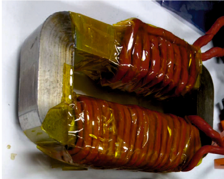
図 4.9 DAB コンバータに使用するトランス
