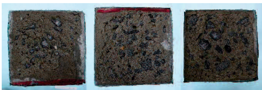
c) 300 サイクル凍結融解試験後の試験体（4面被覆）
