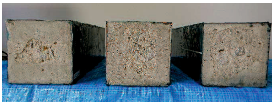
a) 100 サイクル凍結融解試験後の試験体（4面被覆）
