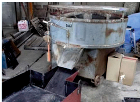
写真-6.4.3 製造に使用したミキサとベッセル
