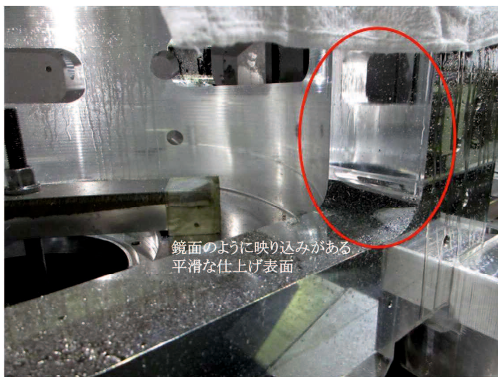
図 5-2 アルミニウム合金製の真空チャンバの表面層を薄く研削加工する様子.
