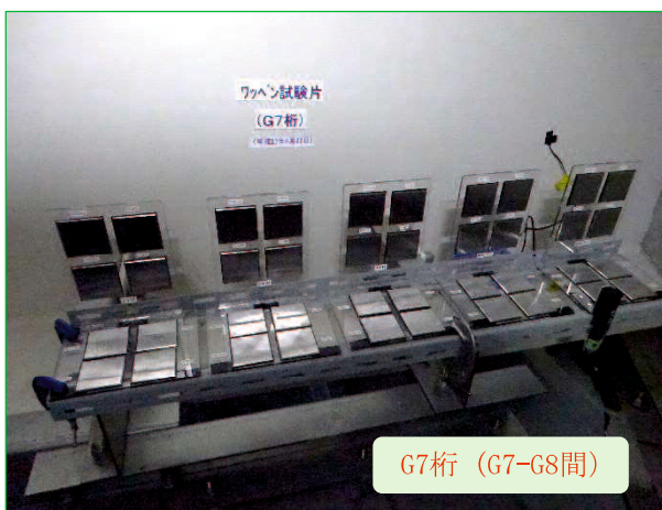
写真-3.7 桁内曝露試験状況
