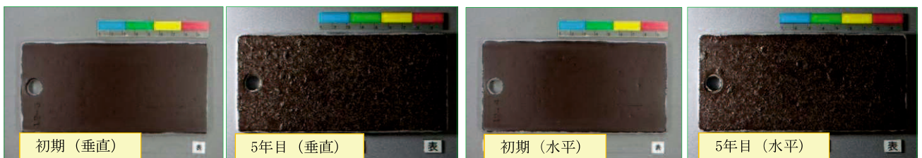
写真-4.15 2種ケレン+さび安定化補助処理
