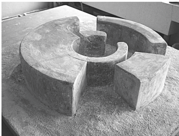
図4 石彫方位盤のFRP模型（未着色段階）
