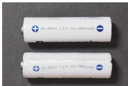
図10. 充電電池 (④) における外観の変化 ( (上) : 測定前、 (下) : 測定後)
