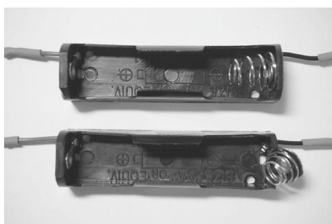
図5. アルカリ乾電池を用いたショート回路の接続前(上)と後(下)のプラスチック製電池BOXの外観変化。接続後に金属スプリング部分(下方右手)で破損が確認された。
