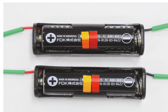
図12. 示温（サーモ）テープを貼り付け、短絡させた際の示温テープの色の変化（短絡中（上）、短絡前（下））。上図において、電池の温度が上昇したことに伴い、貼られた2つのシールの下部の色が変色している様子がわかる。
