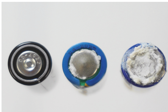
図9. 測定後におけるマイナス極付近での電池の物理的变化 (左からマンガン乾電池 (①) (変化なし)、アルカリ乾電池 (②) (少量の液漏れ)、高品質アルカリ乾電池 (③) (多量の液漏れ))
