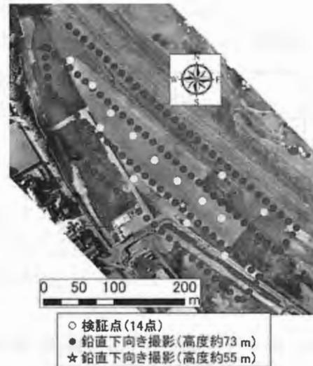
図 1 検証点の配置と鉛直下向き撮影の撮影位置
