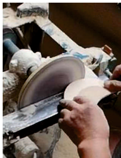
図4-10 表面研磨の手作業（左）と電動研磨機（右）（2019年3月 筆者撮影）
