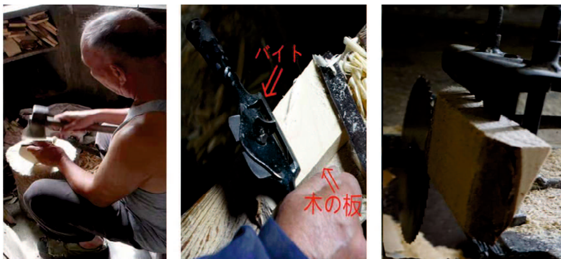
図4-6 バイトと斧の手作業（左と中央）と電動鋸2型（右）の作業 (2019年3月 筆者撮影)
