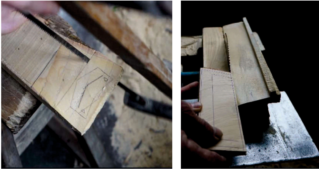
図4-4 長方形に切る 手作業（左）と電動鋸1型（右） （2019年3月 筆者撮影）
