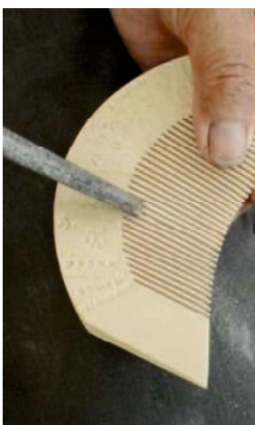
図4-11 木くずを磨き除く手作業（左）と電動ブラシ機（中と右）
