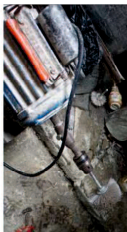
図4-11 木くずを磨き除く手作業（左）と電動ブラシ機（中と右）
