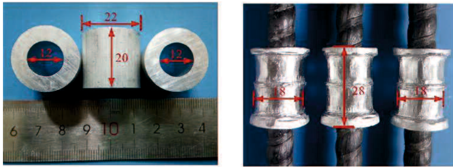
図 2-16 アルミリブを装着したCFRP ロッド [Zhang ら, 2015]
