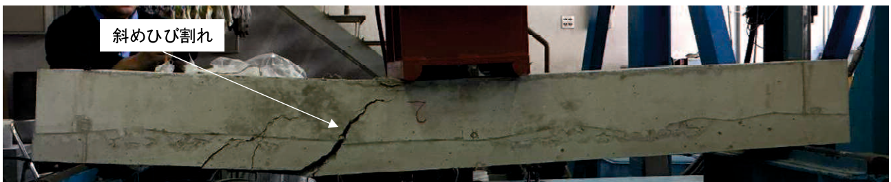
(d) No.5 試験体 (HM12-EC) 破壊状況
