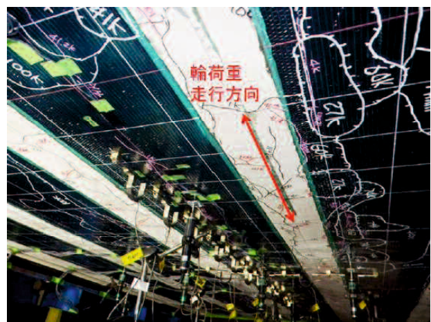
(b) 配力筋方向補強試験体
