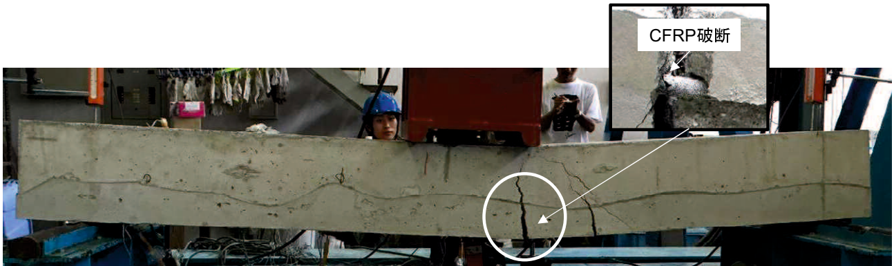
(b) No.2 試験体 (HM12) 破壊状況
