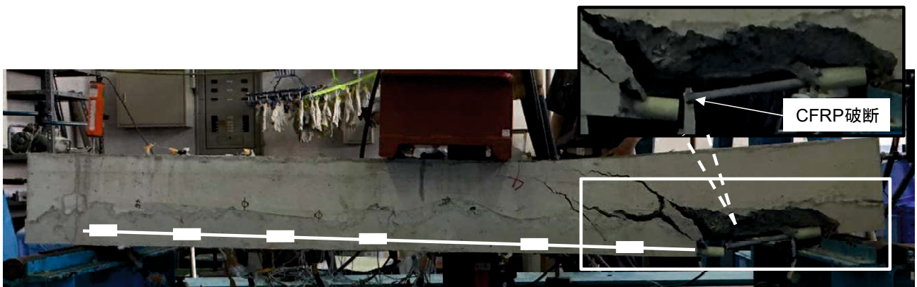
(c) No.4 試験体 (HM12-GS6.0-50-200) 破壊状況
