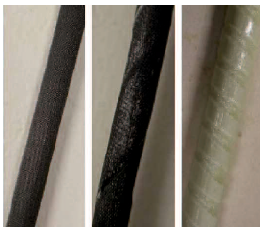
図 2-15 埋設した FRP ロッド [Sharaky ら, 2013 ; 2014 ; 2015]
