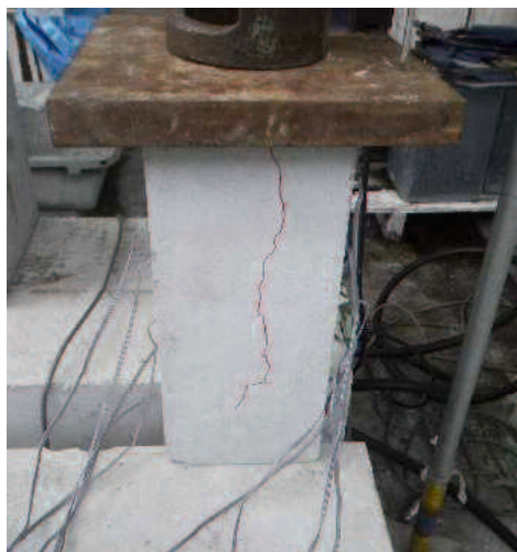
図-4.3.8 ひび割れ発生状況 ( \phi 17\text{mm} \square 150\text{mm} )
