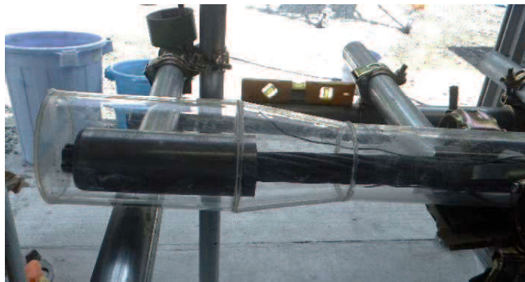
図-3.5.1 固定定着部を模した透明亚克力管
