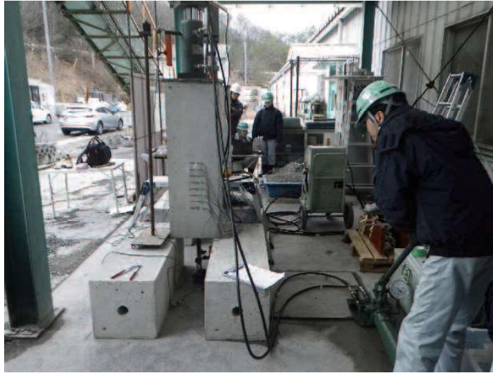
図-3.6.2 引抜き実験状況
