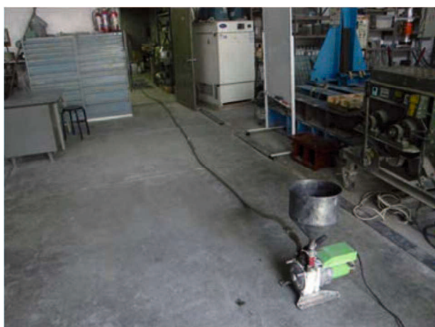
図-3.3.5 圧送実験の様子
