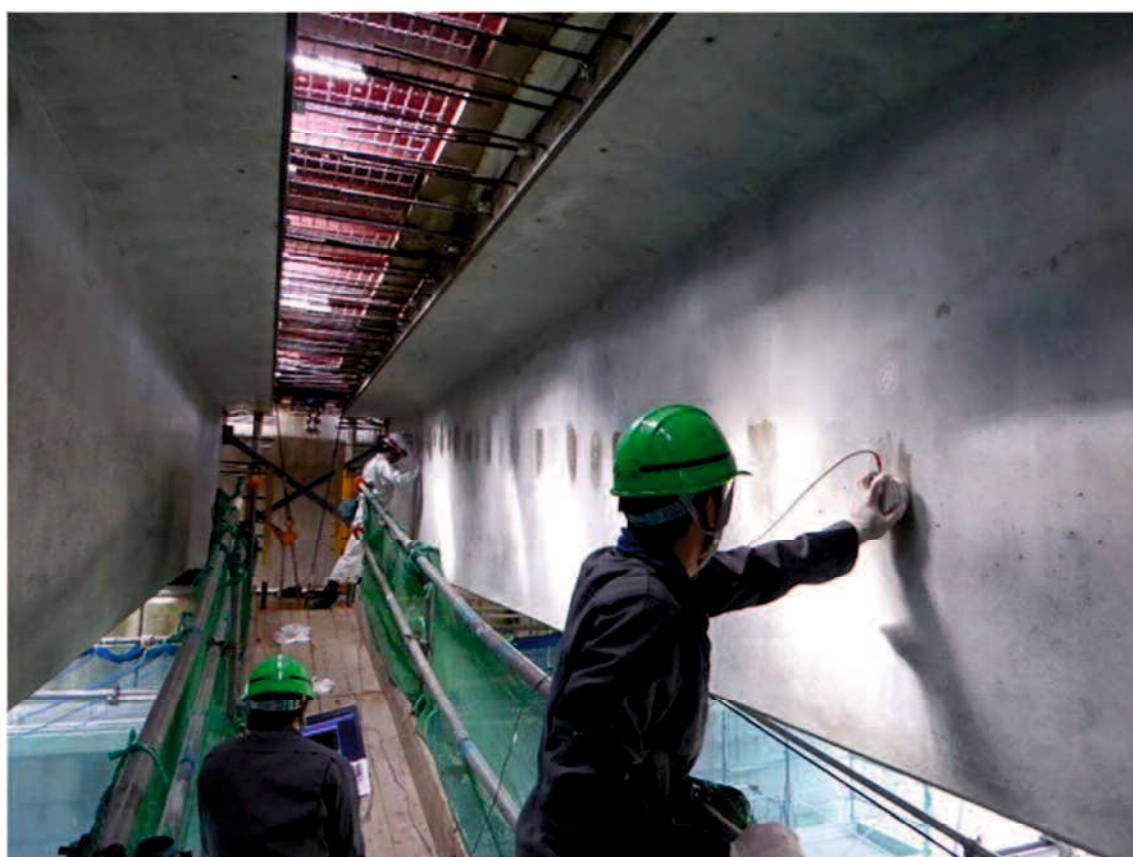
図-4.21 超音波伝搬範囲の実験状況
