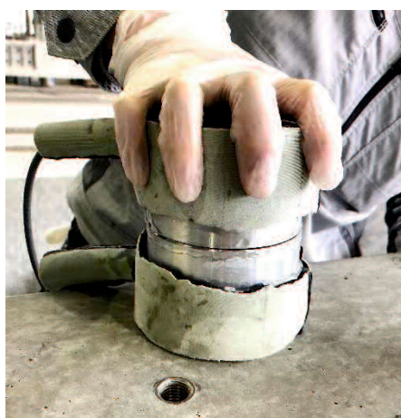
図-4.4 探触子同士を重ね合わせた計測状況
