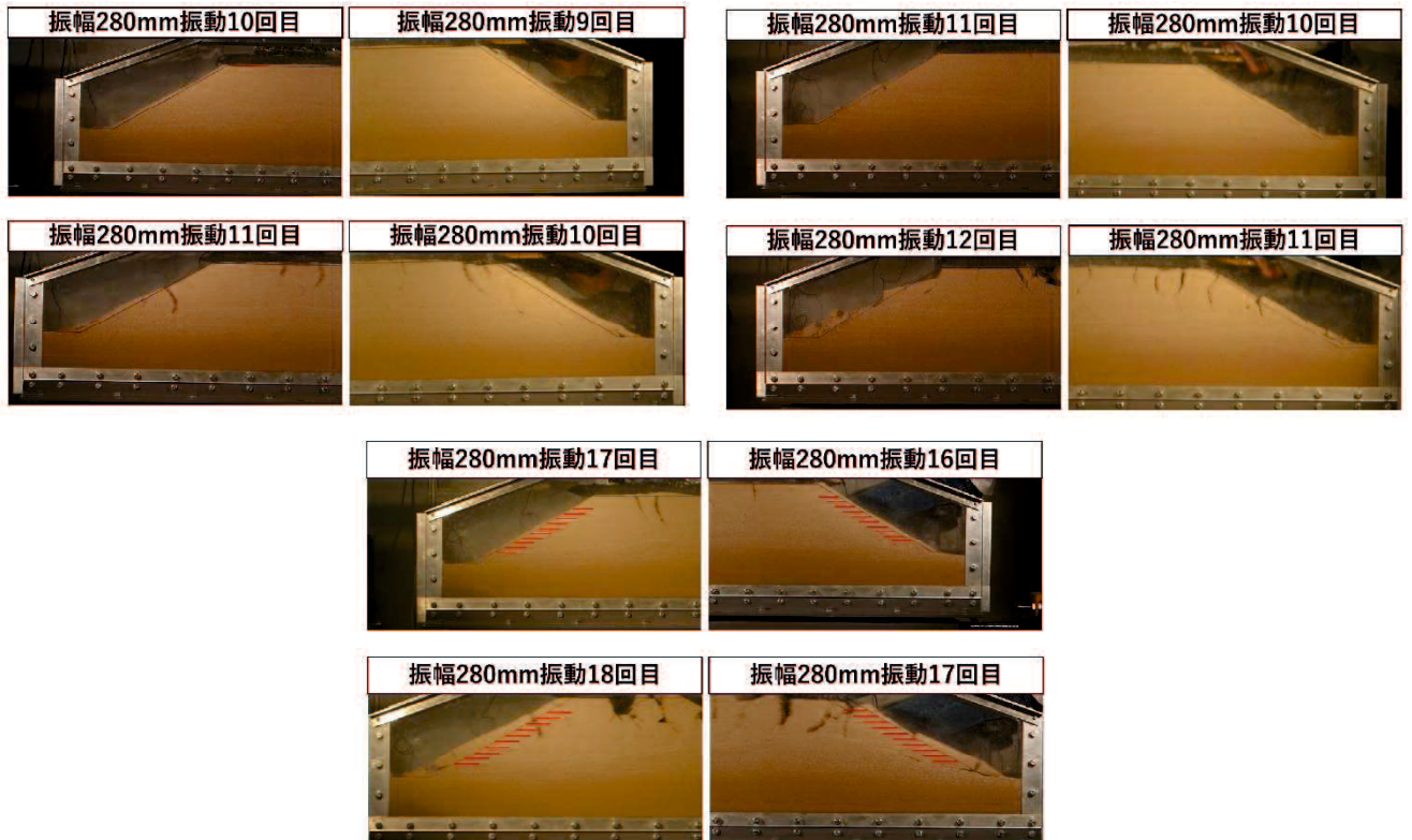
写真 3-5 崩壊 1 回前と崩壊の瞬間 (Case1-a, Case1-c, Case2)
