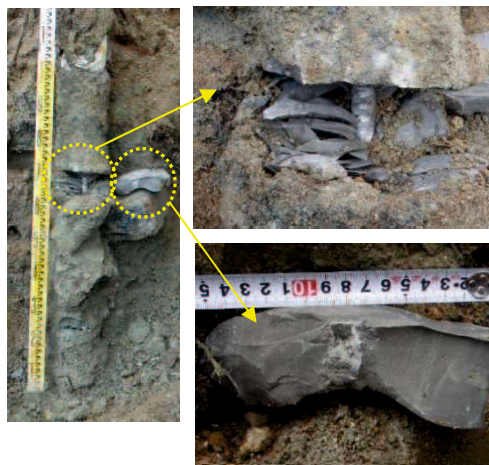
写真 4-7 付着切れ断面状況 (Case16)
