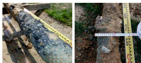
写真 4-9 礫が付着した定着体の状況(左: Case7, Case8)
