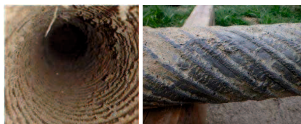
写真 4-8 掘削直後の孔壁と定着体表面の状況(Case1)
