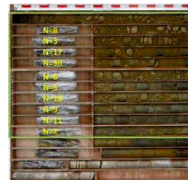
写真 5-9 盛土 I コア
