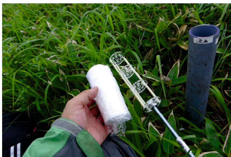
図 6-4 50 mm 径用ロッド 3 本型 PDV(アクリル製)
