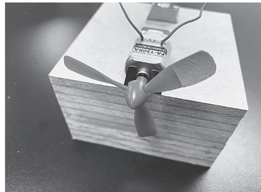
図2. 測定用シール (右上の灰色) が貼られたプロペラとモーター。
