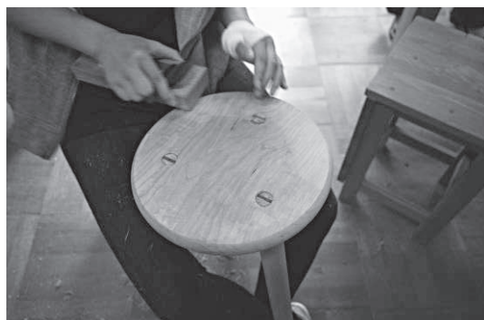
図8 座面を飽で仕上げる様子
