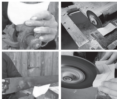
図7 櫛歯を開く 手作業(左)と電動櫛歯開き機(右) (左の二枚は職人のビデオより借用) 筆者撮影
