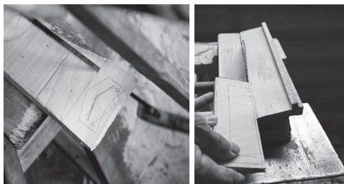
図3 長方形に切る 手作業(左)と電動鋸1型(右) 筆者撮影
