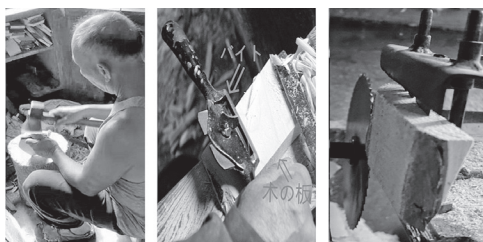
図5 バイトと斧の手作業(左と中央)と電動鋸2型(右)の作業 筆者撮影
