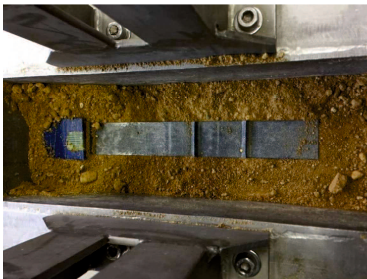
写真-3.3.8 引抜き試験後の補強材の状況
