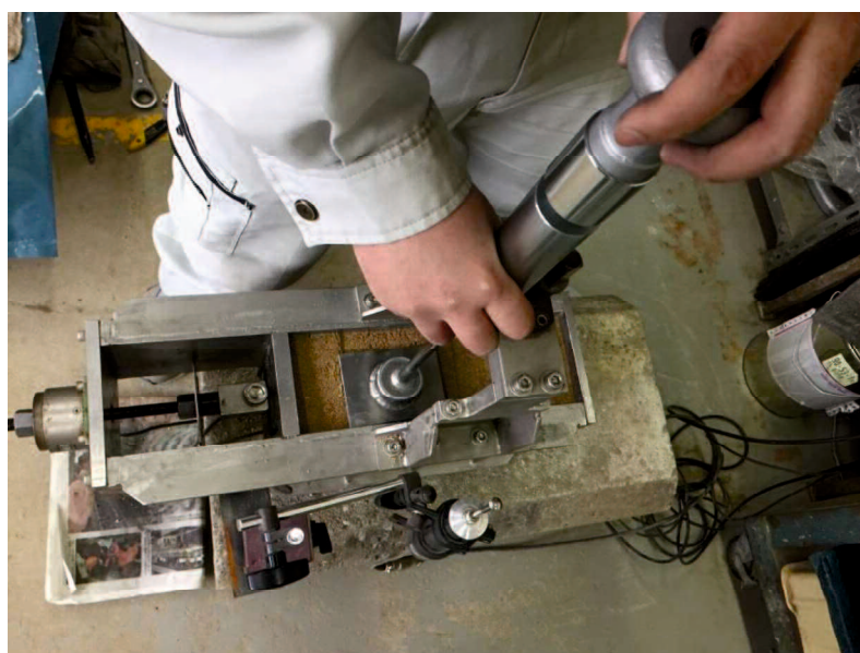
写真-3.3.7 専用ランマーでの突き固め状況
