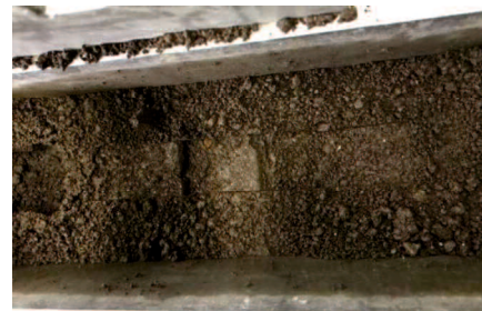
(c) 試験後の補強材下面摩擦抵抗状態
