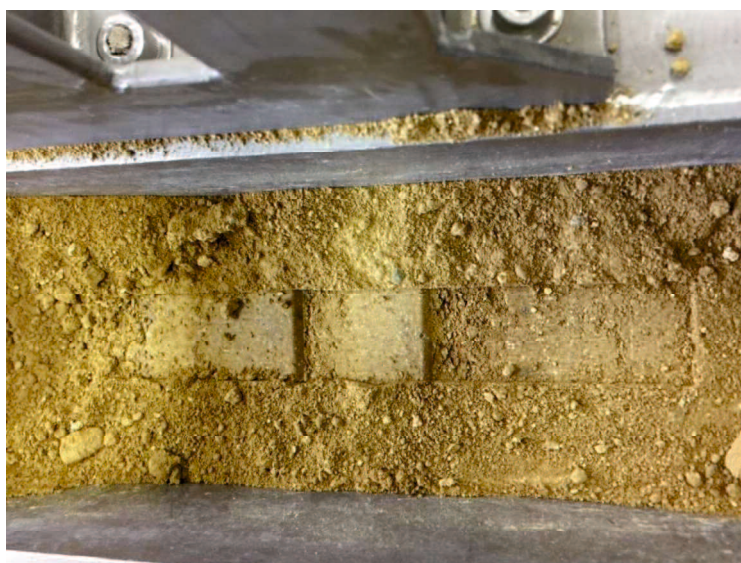
写真-3.3.9 引抜き試験後の補強材下，摩擦面の状況
