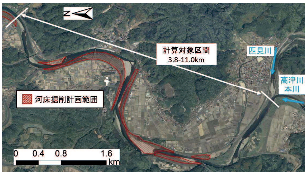
図-5.2 計算対象区間及び計算対象区間における河床掘削計画範囲
