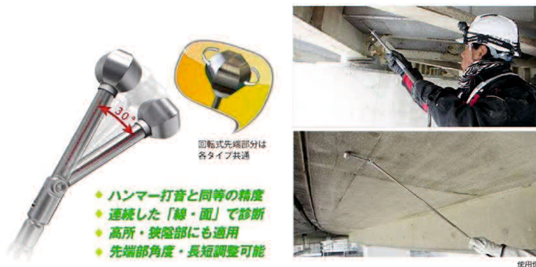
図-2.7 回転式打音検査器の例 19)
