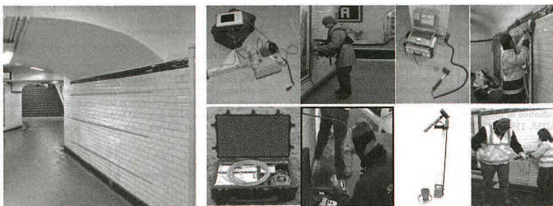
図-2.12 モニタリング手法（テストハンマー・ボアホールカメラ） 28)
