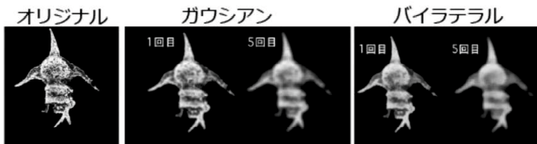
第 31 図 フィルタリングの種類と回数を変えた結果得られた SEM 画像。
