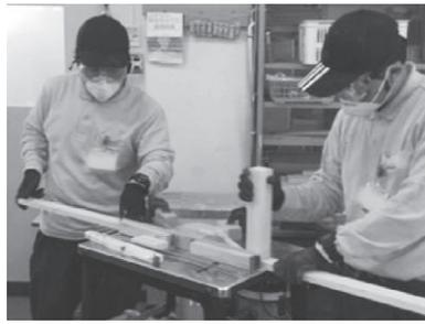
ルーターで台座板の溝を加工
