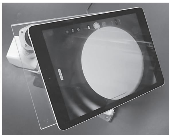
図2 アダプター上にタブレットPCを置いたようす
