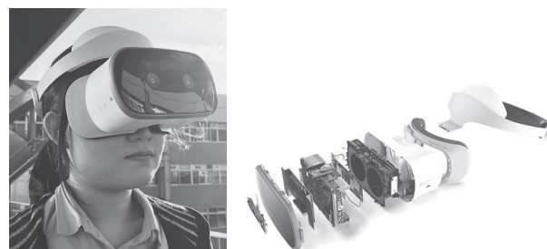
図14 Lenovo Mirage Soloの装着図と分解図
