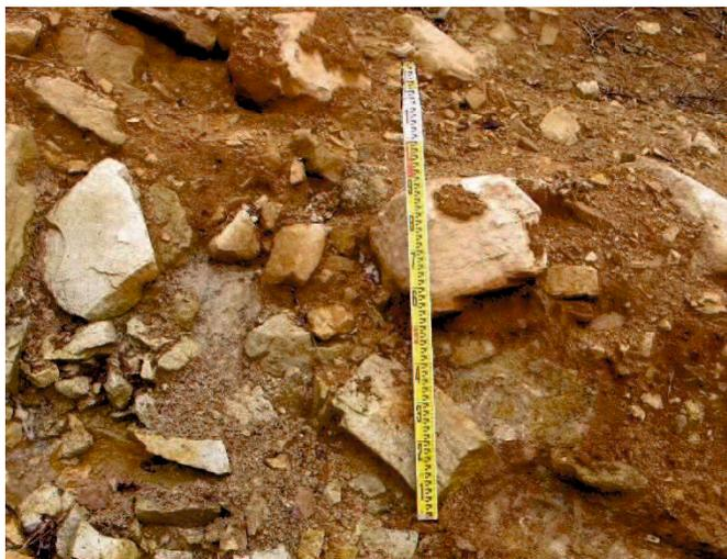
写真-2.2.1 安佐北区可部沢に分布する基質支持の土石流堆積物
