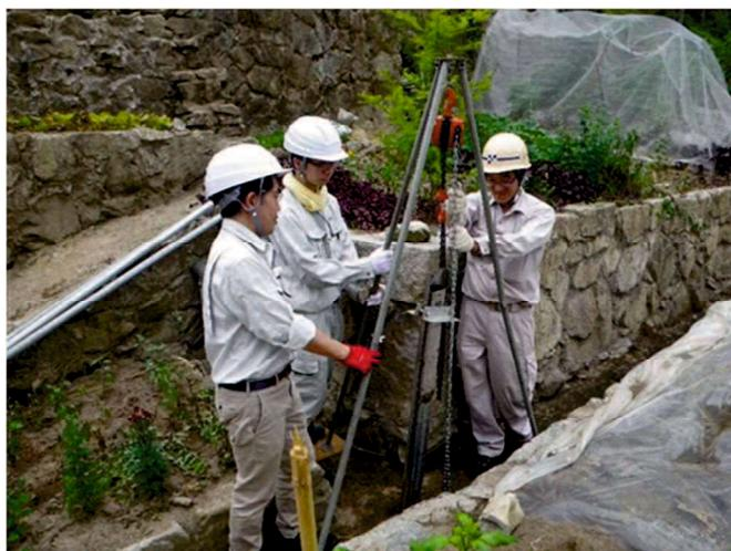
写真-3.3.2 ジオスライサー（ハンディー型）による試料採取状況
