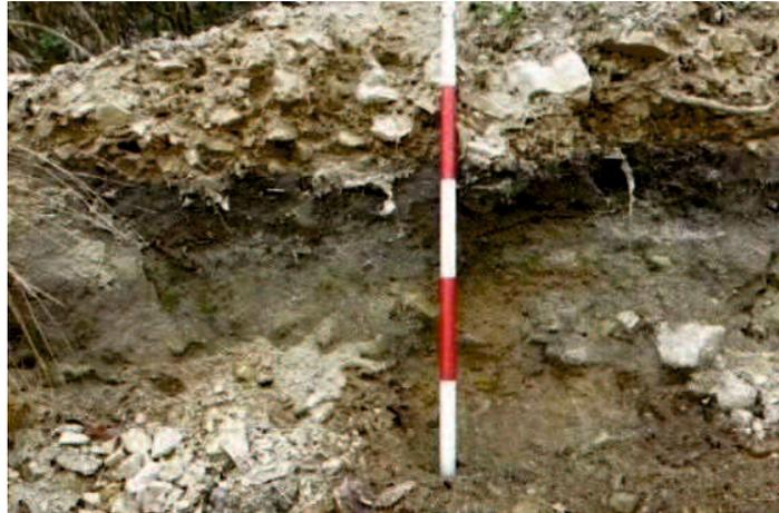
写真-4. 2. 1 土石流堆積物に挟在する有機質土層の分布状況
