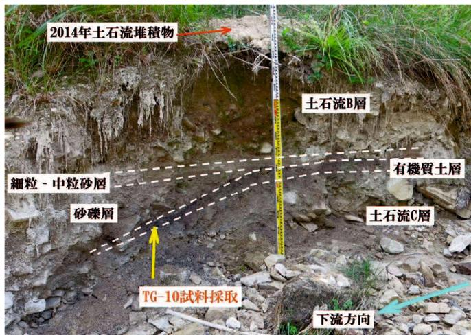
写真-3.4.2 溪岸部の有機質土層および土石流堆積物の状況
