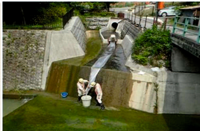
写真-4.2.4 容器法による流量計測状況 (E2)
