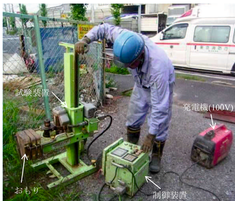
(ii)全自動式の SWS 試験装置 (日東精工株式会社)
