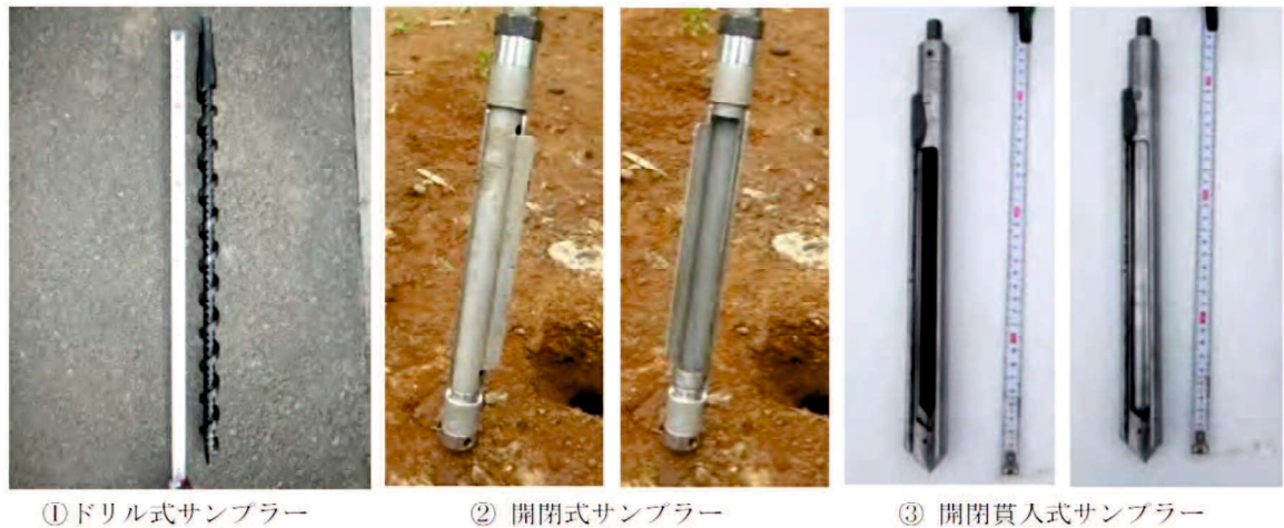
図 1.4-2 SWS 試験後の試験孔を用いて土試料を採取種するための各種サンプラー 36)
