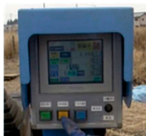
(i)データロガーと操作パネルの外観
