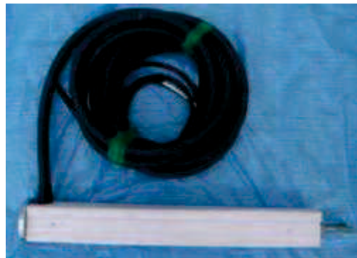
写真4-1 吹付けコンクリート応力計（GK-20N-202，東横エルメス） 7)
