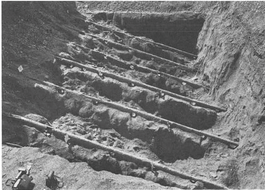
図 2.19 掘り起こしたアンカー体の状況 (Ostermayer and Scheele, 1977) 14)
